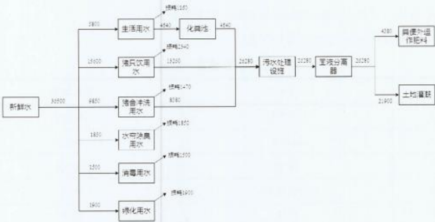
图 2 项目水平衡图 (单位: m³/a)
